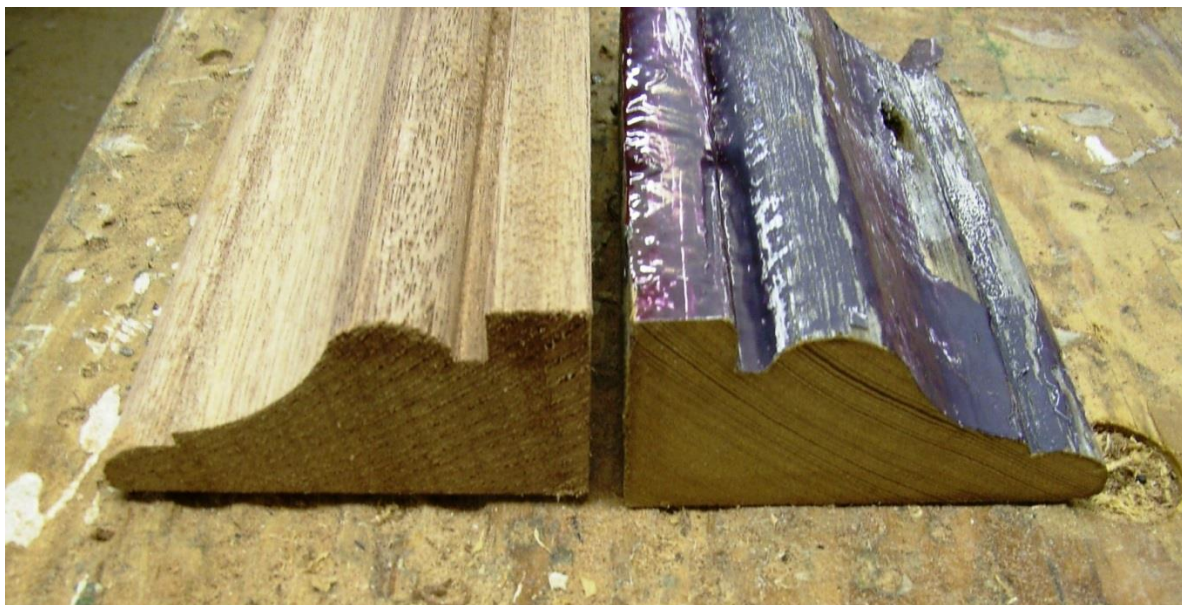
Gekopieerd lijstprofiel. Het origineel is niet ontverfd voor het kopiëren, wat afwijkingen kan veroorzaken in de maatvoering. Tevens is een niet-geëigende houtsoort gebruikt (meranti)
